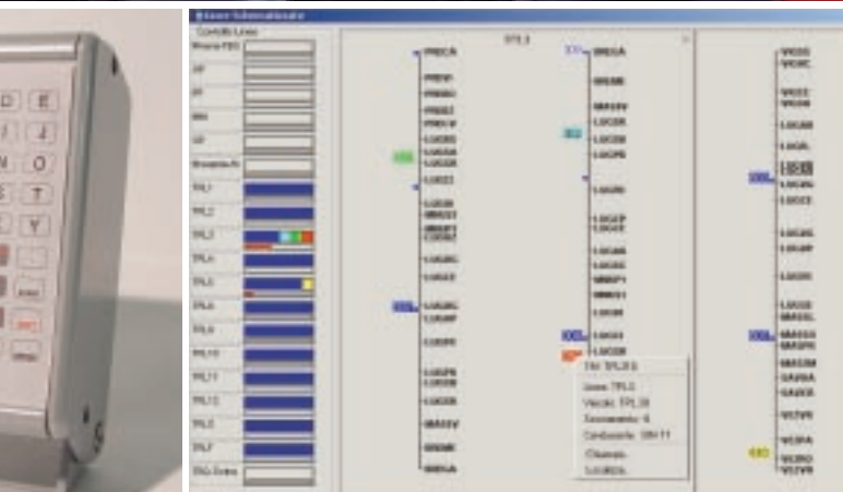
Sopra, una videata del software per il controllo delle linee di una flotta di autobus. Funzioni analoghe possono essere realizzate per una flotta di camion. A lato, tre schermate del sistema Teq Monitoring per la Taboga. Da destra: la posizione dei veicoli; il report dell'attività di un mezzo chiamato ogni dieci minuti; la posizione di tutti i veicoli fuori sede.
