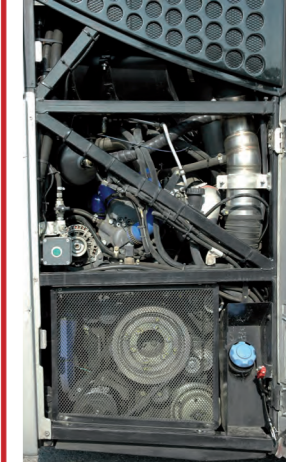
Vano laterale d'ispezione con attacco rapido (tasto verde).
