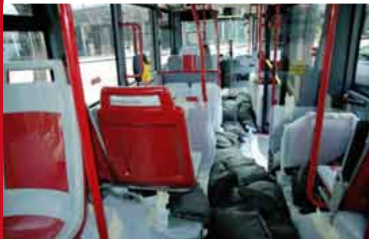
Postazione disabili, nella foto a destra, con pedana manuale; sotto, l'abitacolo, in configurazione suburbana, omologato per 35 passeggeri in piedi, e 12 sedili, tra cui un jumbo, più 2 strapuntini; in basso, a destra, il biposto. I sedili sono Fainsa o Ster.
