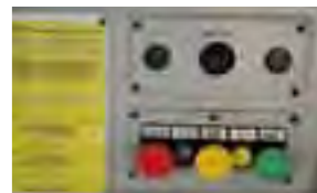
Comandi manuali per alloggiare la carrozzella.
